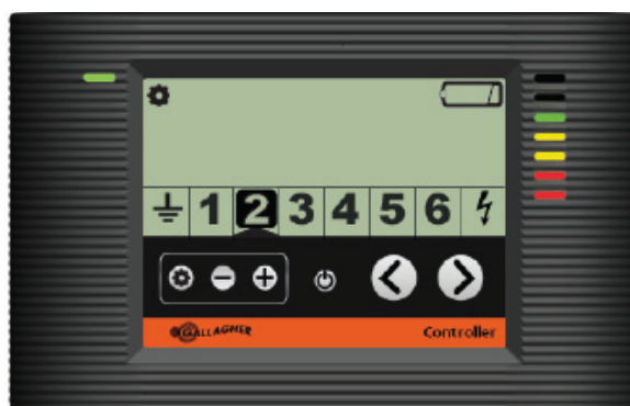
Controlador mostrando la zona 2 con batería baja
