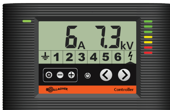
Controlador mostrando que el Energizador funciona normalmente
