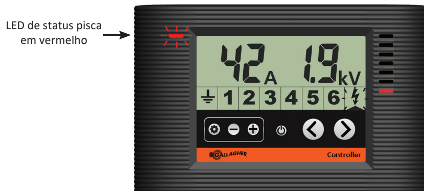
Controlador mostrando o energizador no alarme de corrente
