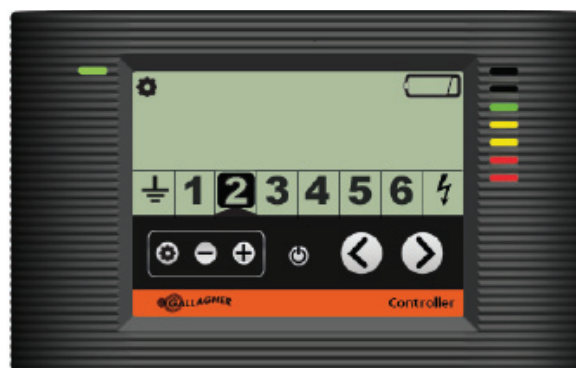
Controlador exibindo a zona 2 com bateria fraca
