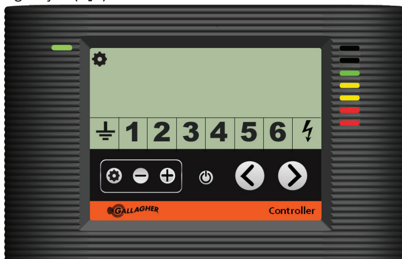
Controlador exibindo a tensão de saída sendo ajustada
