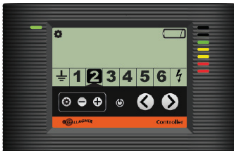
Controlador mostrando la zona 2 con batería baja
