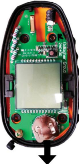
**Bemærk:** Sørg for, at den sorte pakning sidder på plads for at sikre, at fejmåleren er vandtæt.
